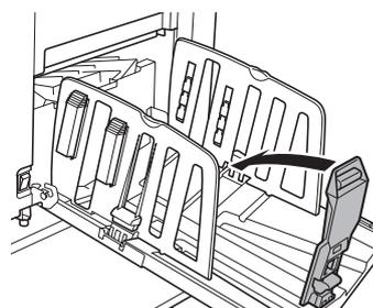
**5** Pliegue las guías del papel de la bandeja de salida hacia dentro.
