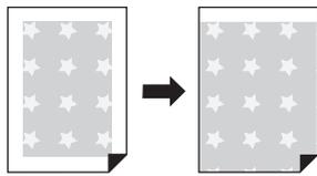
⚠️ ▶ Aunque active [Máxima Exploració], el rango de 5 mm (3/16 pulgadas) desde el borde superior del papel no se utiliza para la creación de masters.
