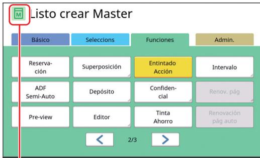
Cuando [Entintado Acción] está activado, cambia el icono que se muestra en el área de mensajes de la pantalla básica de creación de masters.
