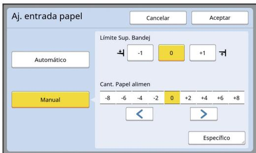
Toque [Específico] para especificar [Sincroniza ON embrag] y [Sincroniz OFF embrag].
