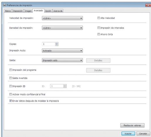
■ **Pantalla de pestaña [Avanzado] [Impresión Auto]:** Antes de la creación de masters y el proceso de impresión, puede detener temporalmente la operación para comprobar la copia de prueba, realizar diversos ajustes, sustituir el papel o realizar otras tareas necesarias.
